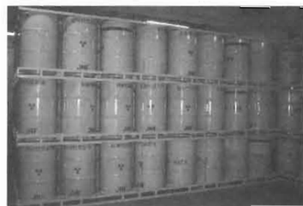
図3 固体廃棄物保管廃棄例
